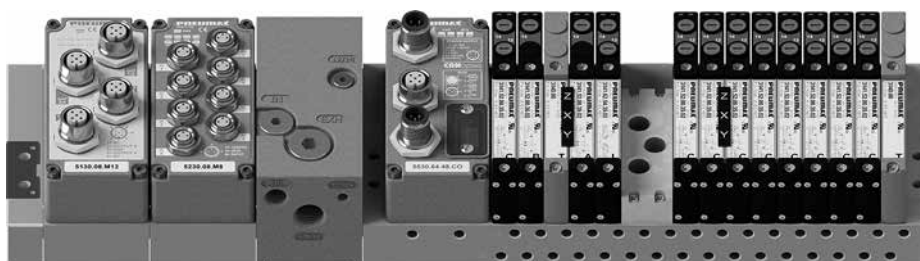
Beispiel: 31-P-C4-D8-M12-E-C-B-T-XYZ-A-I-W-(2)C-XYZ-(6)C-T Ventilinsel Serie 3100, mit externer Vorsteuerung, seriellen Busknoten, M8 Eingangsmodul, M12 Ausgangsmodul, 12 Elektromagnetventilen, 2 mal Leitungstrennung, einem zwischen Ein-/Ausgangsmodul und zwei Verschlussplatten.
