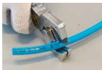
Tubo tagliato in modo corretto con pinza in metallo
