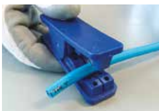
Tubo tagliato a 90° con pinza in plastica
