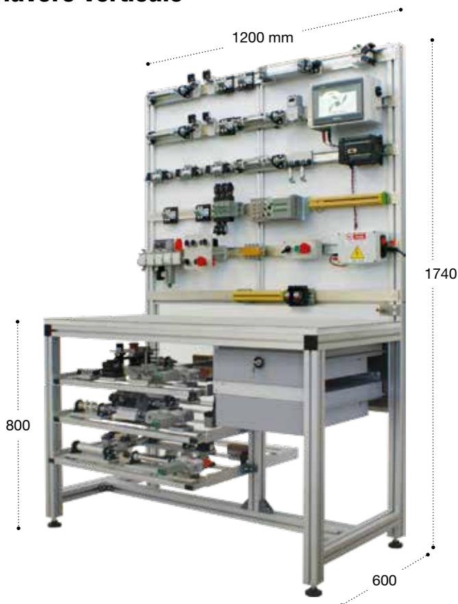
Piano di lavoro verticale costituito da una serie di barre piatte in acciaio sulle quali applicare in maniera semplice e veloce i moduli a fissaggio magnetico, pratico per qualsiasi tipo di circuito. Al piano verticale sono agganciabili i pannelli kit che possono essere riposti nell'apposito spazio sotto il banco. Munito di cassettera e alimentatore a 24 VDC/4A.
