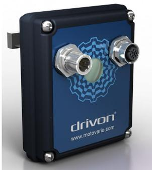
Questo modulo opzionale realizza l'interfaccia hardware e software per reti Ethernet-Real-Time con profilo Profinet. Sulla facciata esterna del modulo sono presenti due connettori M12 D-code femmina per una connessione di tipo Line alla rete di campo.
