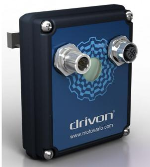
Questo modulo opzionale realizza l'interfaccia hardware e software per reti Ethernet-Real-Time con profilo Ethernet IP. Sulla facciata esterna del modulo sono presenti due connettori M12 D-code femmina per una connessione di tipo Line alla rete di campo.
