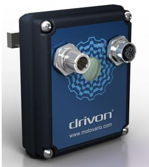
Questo modulo opzionale permette la comunicazione tramite bus di campo standard Profibus DPV1. Il modulo rende disponibile l'assegnazione dell'indirizzo di rete mediante selettori rotativi manuali presenti a bordo così come la resistenza di terminazione attivabile, qualora necessario, mediante jumper a disposizione dell'utente. Sulla facciata esterna del modulo sono presenti due connettori M12 B-code (maschio e femmina) per una connessione di tipo Line alla rete di campo.
