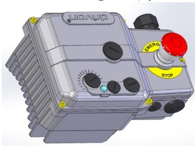
L'opzione consiste nella disponibilità esterna di un pulsante di emergenza che attiva la funzione STO di Drivon. La pressione del pulsante interrompe l'alimentazione del motore in assoluta sicurezza secondo EN ISO 13849-1 e EN61508, conservando invece l'alimentazione dell'inverter.
