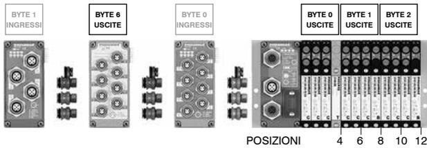
In questo caso i Byte 3-4-5 non sono utilizzati poiché assegnati in modo fisso al manifold principale, il quale non prevede elettrovalvole nelle posizioni corrispondenti.
