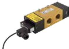
**Elektromagnetventil zum Ein- und Auschalten der Druckversorgung und zur Entlüftung des Druckluftsystems - 3/2 Wege, G1/2"- Serie 412/2 kompakt**
