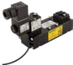
**Elektromagnetventil zum Ein- und Auschalten der Druckversorgung und zur Entlüftung des Druckluftsystems - 5/2 Wege - Serie 1000 ISO 5599/1**
