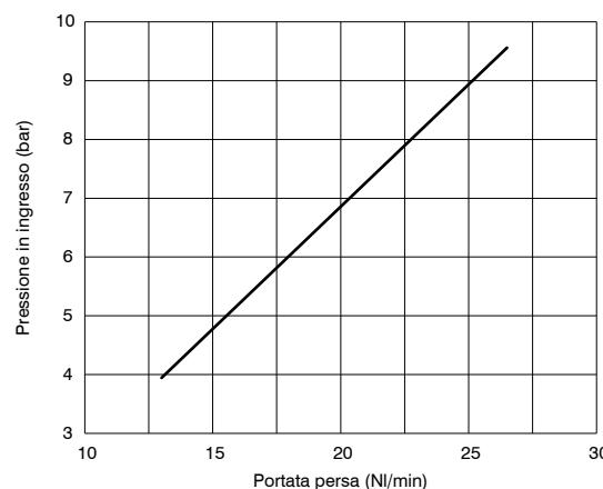
Per un'efficienza di essiccazione maggiore, impiegare una pressione in ingresso più alta possibile, anche se ciò comporta un aumento dell'aria di rigenerazione.
