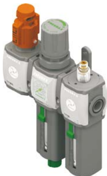
Příklad: GT171BVHG : Kombinovaná sestava velikost 1 obsahující uzavírací ventil, filtr s red. ventilem a maznicí s technopolymerovými závity G1/4", regulační rozsah 0 - 8 bar, filtrace 20 µm
