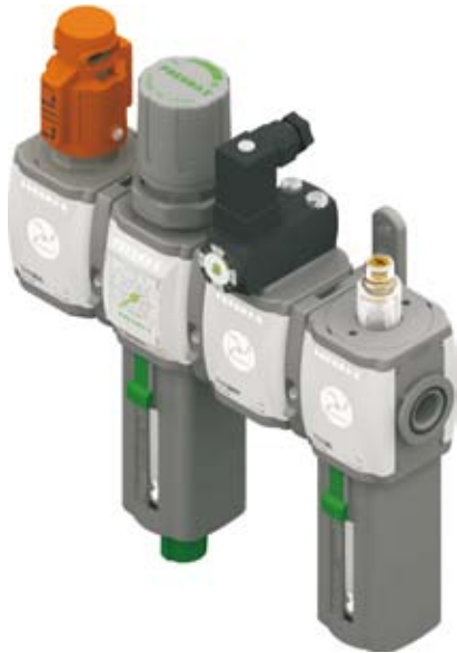
Příklad: GT171BVRG : Kombinovaná sestava velikost 1 obsahující manuální uzavírací ventil, filtr s red. ventilem, tlakový spínač a maznici s technopolymerovými závity G1/4", regulační rozsah 0 - 8 bar, filtrace 20 µm
