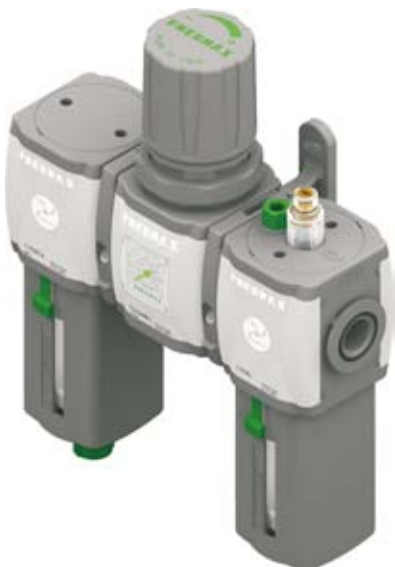
Příklad: GT172BKG : Kombinovaná sestava velikost 2 obsahující filtr, red. Ventil a maznici se technopolymerovými závity G3/8", regulační rozsah 0 - 8 bar, filtrace 20 µm
