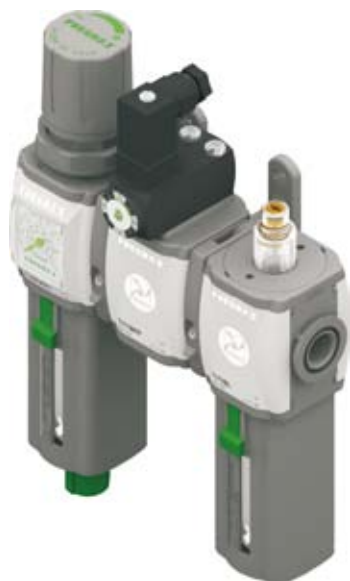
Příklad: GT171BRG : Kombinovaná sestava velikost 1 obsahující filtr s red. ventilem, tlakový spínač a maznici s technopolymerovými závity G1/4", regulační rozsah 0 - 8 bar, filtrace 20 µm
