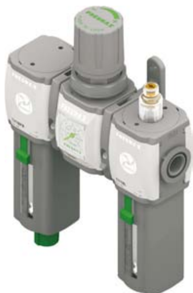
Příklad: GT171BKG : Kombinovaná sestava velikost 1 obsahující filtr, red. Ventil a maznici se technopolymerovými závity G1/4", regulační rozsah 0 - 8 bar, filtrace 20 µm
