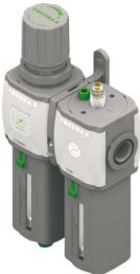
Příklad: GT173BHG : Kombinovaná sestava velikost 3 obsahující filtr s red. ventilem a maznici s technopolymerovými závity G1/2", regulační rozsah 0 - 8 bar, filtrace 20 µm
