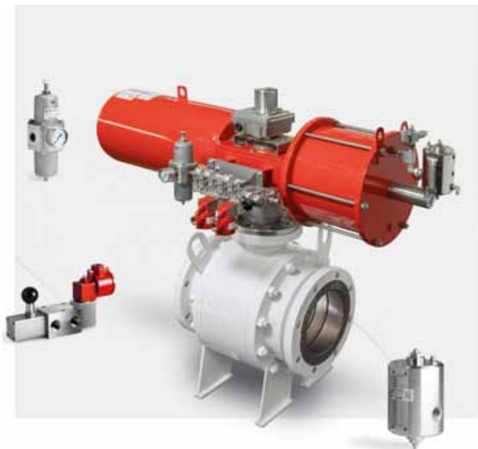
Der Scotch Yoke Stellantrieb: Steuerungseinheit eines pneumatisch gesteuerten Kugelhahns – mit Pneumax Filterdruckregler, Ventilblock und Volumebooster. Foto: Pneumax GmbH
