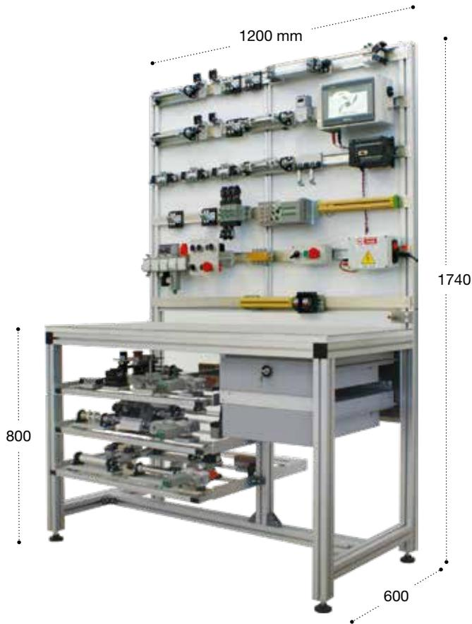
Vertikale Arbeitsfläche, bestehend aus einer Reihe von Flachstahlstäben, auf denen die Module mit Magnetbefestigung einfach und schnell angebracht werden können, praktisch für jede Art von Schaltung. Die Klemmtafeln können am vertikalen Tisch befestigt und in dem dafür vorgesehenen Raum unter der Bank aufbewahrt werden. Ausgestattet mit Schubladen und 24 VDC/4 A-Stromversorgung.
