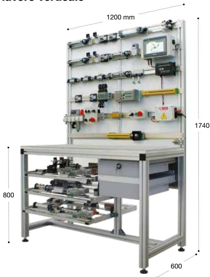
Piano di lavoro verticale costituito da una serie di barre piatte in acciaio sulle quali applicare in maniera semplice e veloce i moduli a fissaggio magnetico, pratico per qualsiasi tipo di circuito. Al piano verticale sono agganciabili i pannelli kit che possono essere riposti nell'apposito spazio sotto il banco. Munito di cassettera e alimentatore a 24 VDC/4A.
