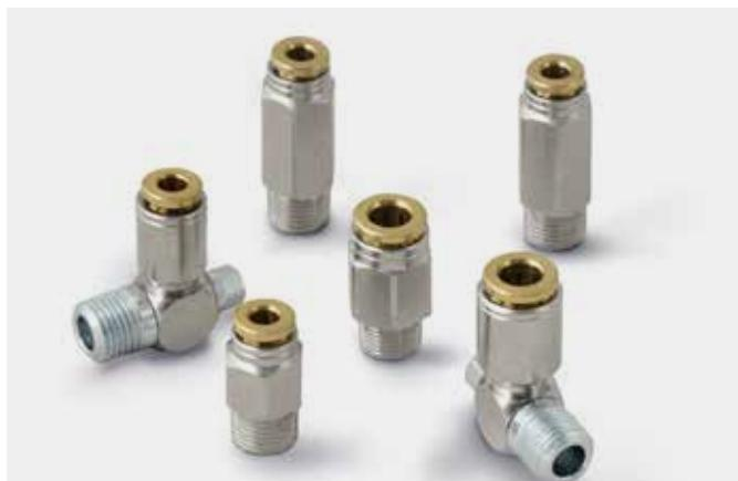
La série de raccords rapides en laiton haute pression peut être utilisée avec des huiles et des graisses dans les systèmes de lubrification et de graissage, avec une pression maximale de 250 bars grâce à une griffe de sertissage spéciale. Ils sont disponibles avec différents filetages UNI ISO 7/1 UNI ISO 228/1 et sont adaptés aux tuyaux rigides et semi-rigides couramment utilisés dans le domaine de la lubrification.
