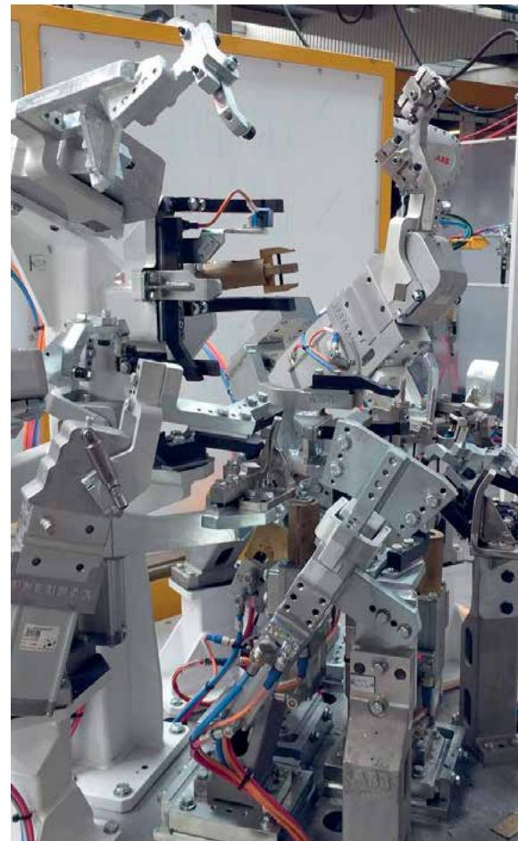
Test di vita. I prodotti sono sottoposti a **test funzionali, prestazionali e di temperatura** per milioni di cicli.
