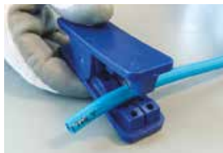
Tubo tagliato a 90° con pinza in plastica
