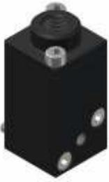
Estas válvulas están disponibles tanto en normalmente abiertas como cerradas. El accionamiento de la válvula N.C. se realiza a través de una rosca de M5 colocada sobre el lateral de la misma válvula, mientras que la versión N.A. debe ser pilotada desde la rosca de G1/8" posicionada sobre la cubierta de la válvula.
