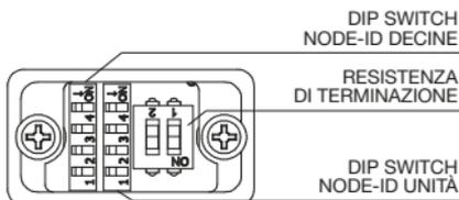
Il dispositivo prevede la **resistenza di terminazione incorporata**; se lo slave è l'ultimo della rete è necessario attivare la resistenza spostando sulla posizione 1 l'interruttore (indicato con colore chiaro in figura).
