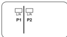
Lo slave CC-Link IE Field Basic è dotato di 2 LED indicanti lo stato delle porte di comunicazione secondo quanto qui di seguito schematizzato:
