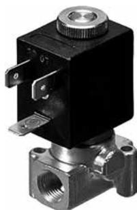
La función biestable se logra mediante el uso de un imán permanente polarizado que energiza la bobina con una corriente continua de al menos 15ms en la dirección inversa del impulso anterior.
