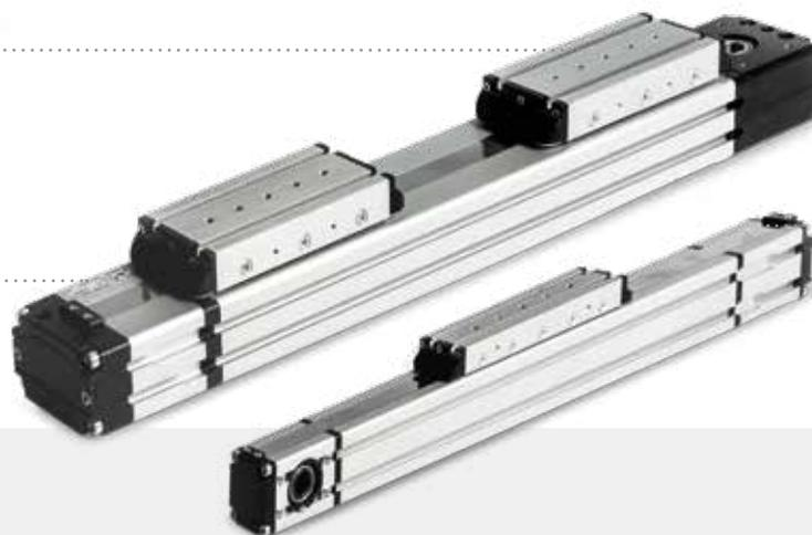
Gli attuatori lineari a cinghia sono dotati di cinghia dentata in poliuretano rinforzato con trefoli in acciaio e sistema integrato di tensionamento. Sono disponibili nelle versioni con una o due guide a ricircolo di sfere integrate per supportare ogni tipo di carico.
