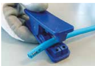
Tubo tagliato a 90° con pinza in plastica
