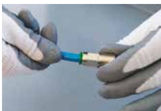
Raccordo con tubo inserito e in trazione
