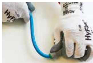
Raccordo con tubo inserito avente raggio di curvatura stretto
