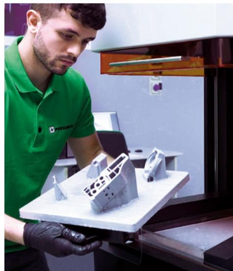
in serie. L'Additive Manufacturing si rivela inoltre una risorsa preziosa anche per la realizzazione di piccoli lotti produttivi o singoli pezzi speciali, destinati a test o applicazioni su misura.
