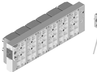
5. Agganciare la batteria alla guida DIN dal lato predisposto, serrare i grani di fissaggio con l'apposita chiave a brugola. **NON FORZARE**
