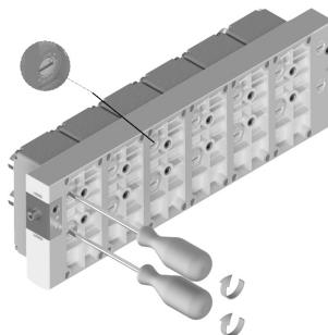
3. Completare ogni configurazione con il 'Kit terminale sinistro'.
