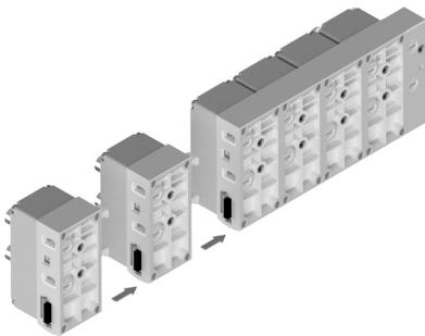
2. Fissare alla batteria i moduli inseriti
