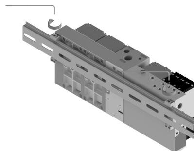
Per integrazione con batterie di elettrovalvole serie EVO smontare il terminale destro.
